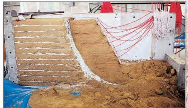
(補強材+表面保護パネル)の破壊後の様子
