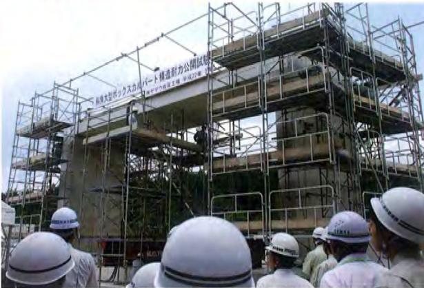
実物大供試体を作成し、施工性や構造性能の検証試験を行い、想定どおりの施工が可能であること、一体型と同等の性能を有していること等を確認しました。
